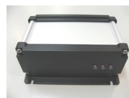
QZSS 対応多周波マルチ GNSS 受信機ユニット
