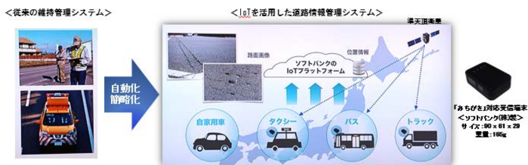
図22 みちびきを活用した IoT 路面情報検知システム
