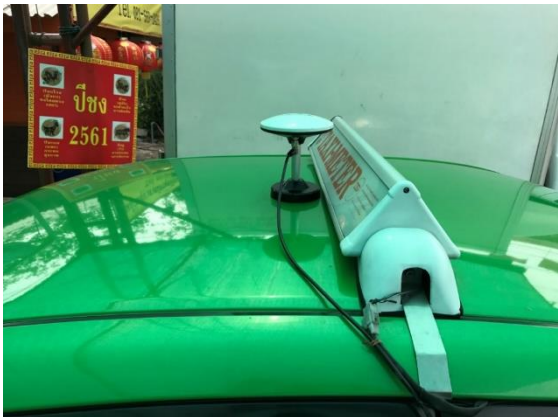
プローブカーに取り付けた受信機アンテナの様子
