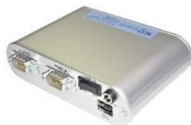
⑥[発売中] マゼランシステムズジャパン株式会社 多周波マルチGNSS受信モジュール (ディスクリート版)評価キット MJ-3021-GM4-QZS-EVK 130x90x42 330g(本体) Φ148mm 405g(アンテナ)
