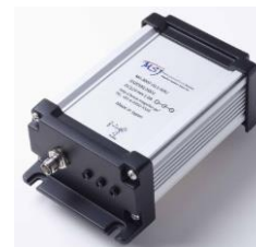
⑦[発売中] マゼランシステムズジャパン株式会社 多周波マルチGNSS受信モジュール+ IMU(ディスクリート版)評価キット MJ-3021-GM4-QZS-IMU 179x106x62 850g(本体) Φ148mm 405g(アンテナ)
