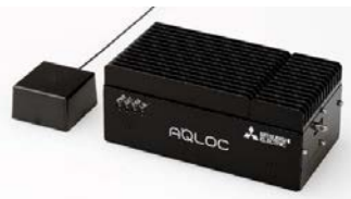
③[発売中] 三菱電機株式会社 AQLOC-VCX 184x98x74mm 1.6kg以下(本体) 59x59x33mm 0.15kg以下(アンテナ)
